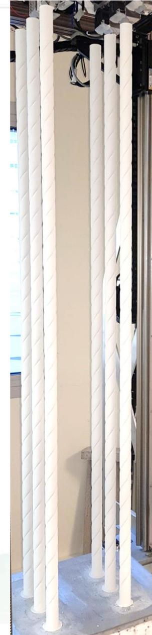
**Les membranes à multicanaux twistés génèrent des turbulences qui réduisent le colmatage**
